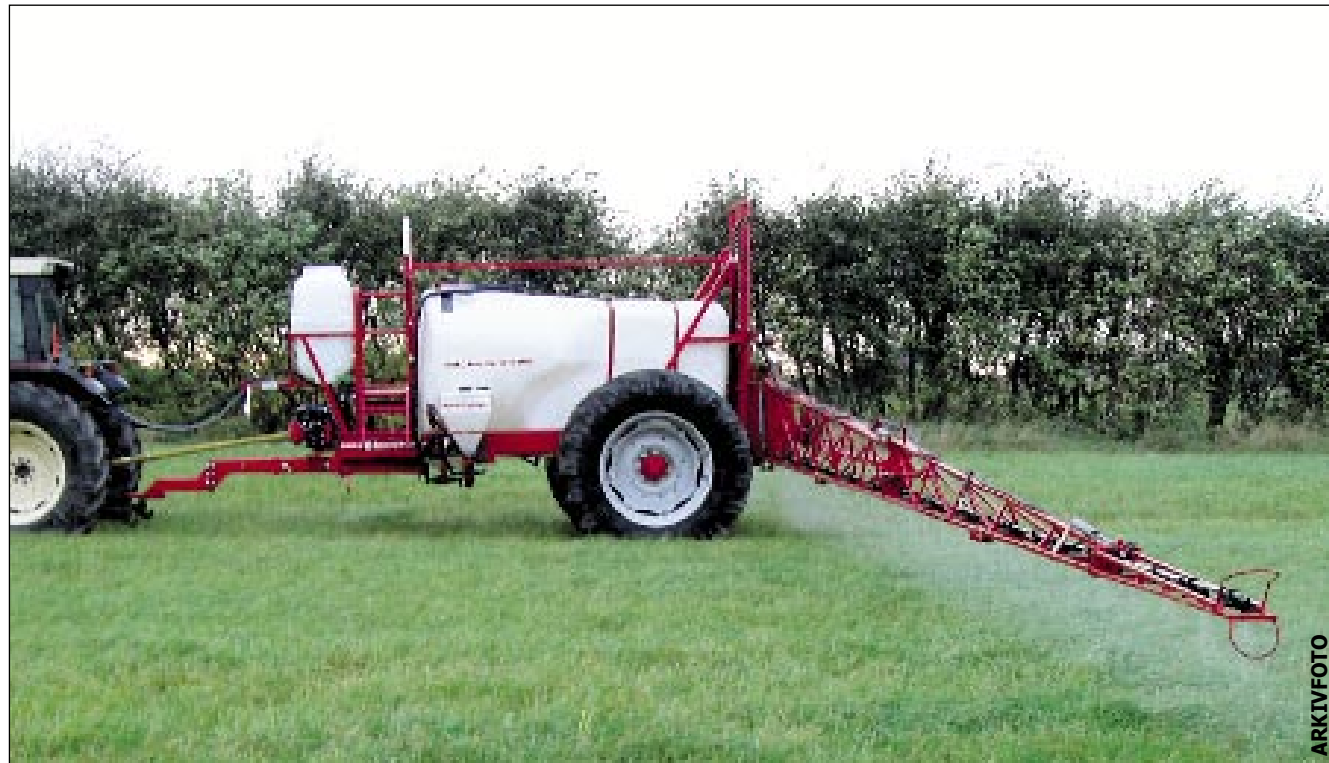
Spild og skyllevand fra en sprøjte sker bedst på en betonfæstet plads med afløb til gyllebeholder. Alternativt kan man, som her, benytte et græsbelagt areal, hvor midlerne bliver bundet og efterhånden nedbrudt.
